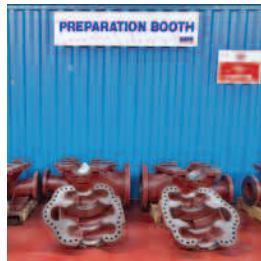
Corps de pompes à plan de joint horizontal ouverts en vue d'être préalablement préparés pour la pose d'un revêtement efficace.
