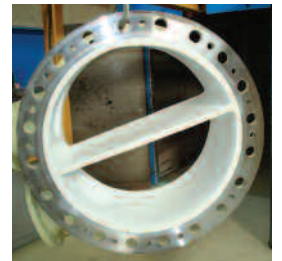
Redresseur pour une centrale électrique après revêtement complet et usinage.
