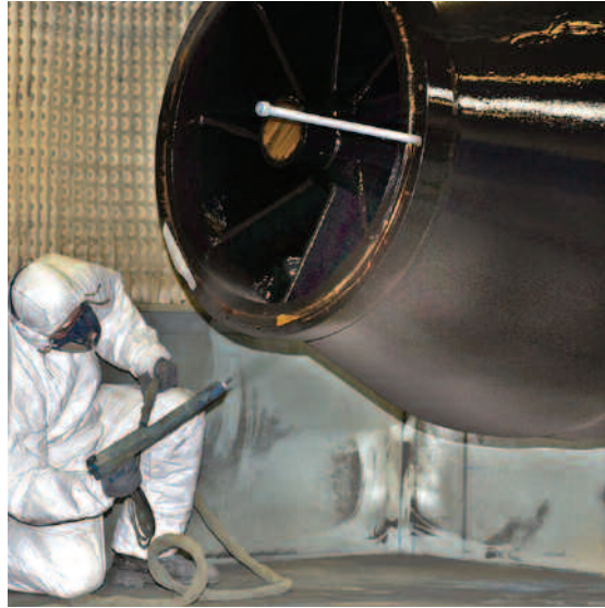
Large diffuseur / corps de pompe recevant un revêtement en poudre anti-abrasion.
