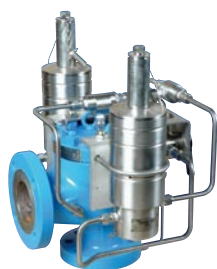
SERIE 76 ASME Раздел VIII API STD 520 – STD 526 ISO 4126 Длинное седло Управление: хлопк. или модуль. Ввод: от 1" до 12" Уст давл: до 431 бар (изб.) Темп.: от -196°C до +345°C Мат.: Сталь – Нерж. сталь – Спец. сплавы
