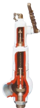
SERIE 9 ASME Раздел VIII API STD 520 - ISO 4126 Длинное седло Ввод: от 1/2" до 11/2" На резьбе – На фланцах – Ввариваемый – На защелках Уст давл: до 431 бар (изб.) Темп.: -196°C à +400°C Мат.: Сталь – Нерж. сталь – Специальные сплавы
