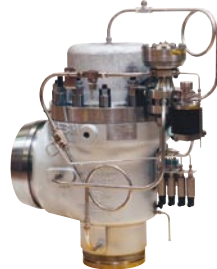
SERIE 86 ASME Раздел VIII ISO 4126 Длинное сопло Управление: хлопк. Ввод: от 1" до 8" Уст давл: до 180 бар (изб.) Темп.: до 550°C Мат.: Сталь – Нерж. сталь
