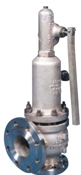
Starflow ASME Раздел VIII API STD 520 – STD 526 ISO 4126 Длинное седло Ввод: от 1" до 12" Уст давл: до 431 бар (изб.) Темп.: от -196°C до +540°C Мат.: Сталь – Нерж. сталь – Специальные сплавы
