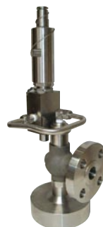
SERIE 71 ASME Раздел VIII API STD 520 - ISO 4126 Длинное седло Управление: хлопк. Ввод: от 1/2" до 11/2" На резьбе – На фланцах – Ввариваемый – На защелках Уст давл: до 431 бар (изб.) Темп.: -50°C à +450°C Мат.: Сталь – Нерж. сталь – Специальные сплавы
