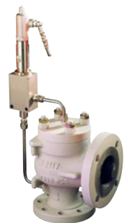
SERIE 78 ASME Раздел VIII API STD 520 – STD 526 ISO 4126 Короткое седло Управление: хлопк. или модуль. Ввод: от 1" до 8" Уст давл: до 431 бар (изб.) Темп.: от -50°C до +250°C Мат.: Сталь – Нерж. сталь – Спец. сплавы
