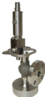
SERIE 71 ASME Раздел VIII API RP 520 – ISO 4126 Длинное седло Управление: пруж. Ввод: от 1/2" до 11/2" На резьбе – На фланцах – Ввариваемый – На защелках Уст давл: до 431 бар (изб.) Темп.: -50°C à +450°C Мат.: Сталь – Нерж. сталь – Специальные сплавы
