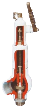
SERIE 9 ASME Раздел VIII API RP 520 – ISO 4126 Длинное седло Ввод: от 1/2" до 11/2" На резьбе – На фланцах – Ввариваемый – На защелках Уст давл: до 431 бар (изб.) Темп.: -196°C à +400°C Мат.: Сталь – Нерж. сталь – Специальные сплавы
